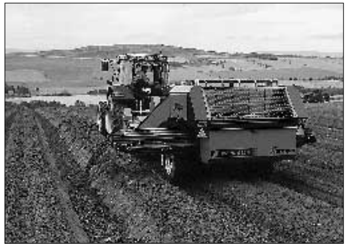
Bild 2: Die Absiebmaschine REL 5154S legt Kluten und Steine über das seitliche Austragsband ab
