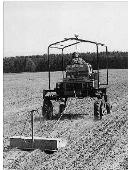
Bild 1: Gerät zur Messung der elektrischen Bodenleitfähigkeit (EM-38)
