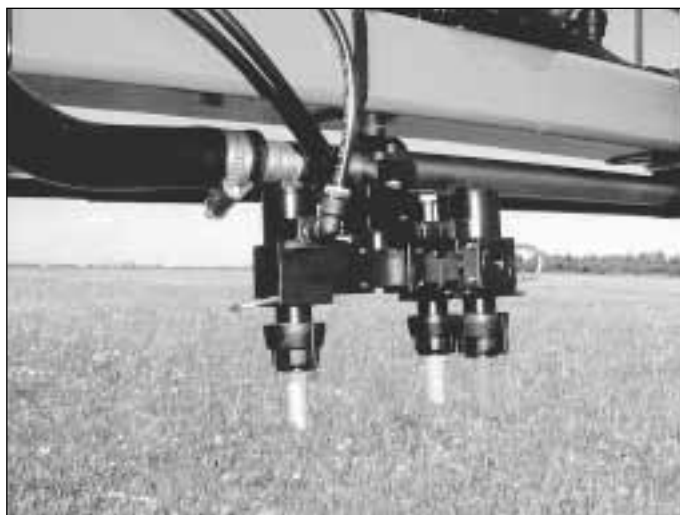
Schaltbare Düsenkörper für ein intelligentes Düsengetriebe für drei Düsen brachten Amazone eine DLG-Silbermedaille
