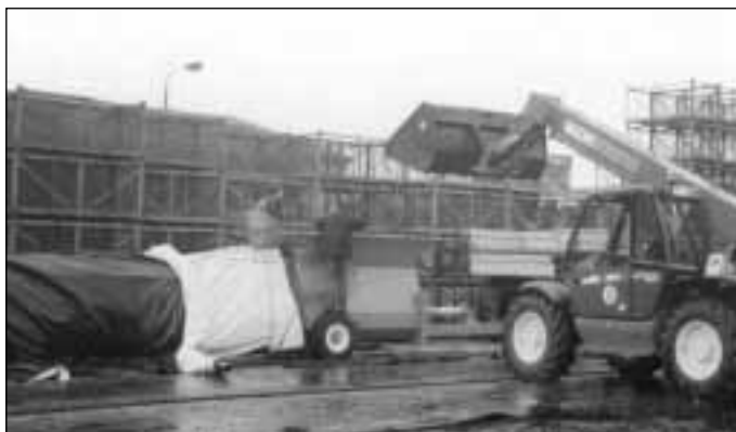
Bild 2: Befüllen des Folienschlauchfermenters
