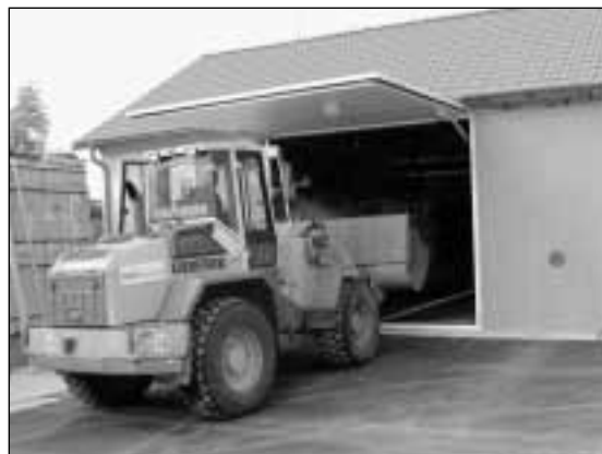
Bild 1: Befüllen des Boxenfermenters mit Radlader
