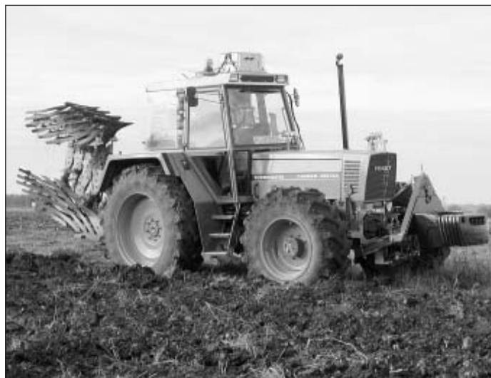
Bild 1: Forschungs- traktor mit stufenlos geregeltem Allradan- trieb [1]
