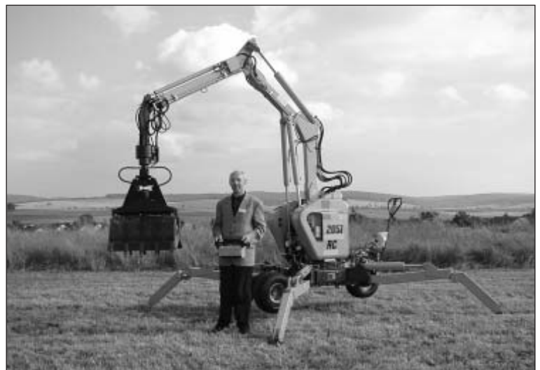
Bild 1: Funkfern-gesteuerter Kompaktbagger BOKI 2051RC
