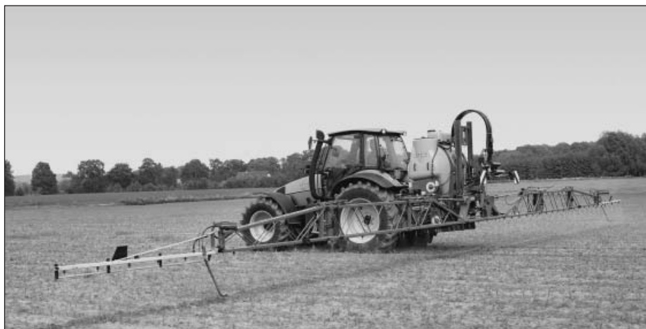
Bild 2: Kennzeichen moderner Anbaufeldspritzen sind schmale, schwerpunkt günstige Behälter. Hier die neue UF 01 von Amazone mit 1800 l Fassungsvermögen und einer Arbeitsbreite bis 28 m.
