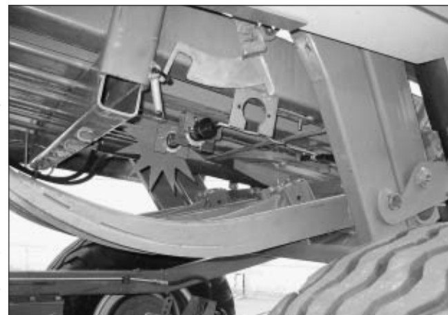
Bild 3 und 4: Für sein Großpacken-Verfahren Big Pack MultiBale erhielt Krone eine Silbermedaille. Oben (Foto Krone) der portionsweise gepackte Großpacken, unten (Foto Dr. Metzner) die Doppelschwinge als Voraussetzung hierzu.
