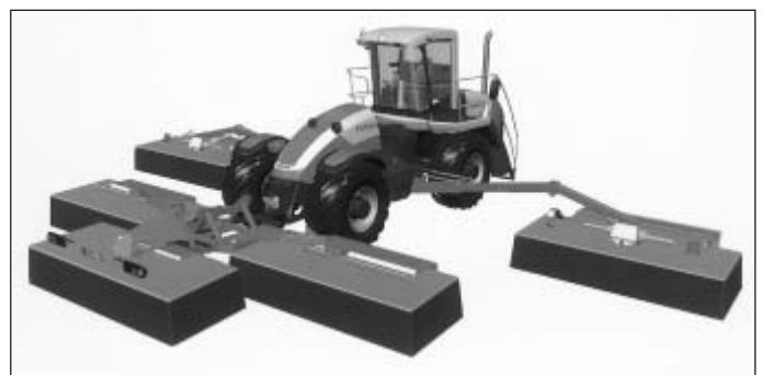
Bild 1: Auf der Agritechnica stellt auch Claas ein selbstfahrendes Mähwerk vor, das eine Arbeitsbreite von über 14 m aufweist. Foto Claas
