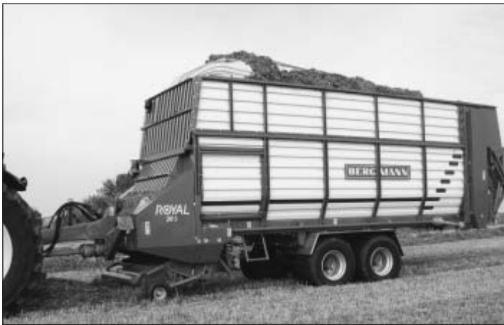
Bild 2: Moderner Ladewagen von Bergmann mit 2-Rotor-Ladetechnologie und Fassungsvermögen bis 48 m 3 Foto Bergmann
