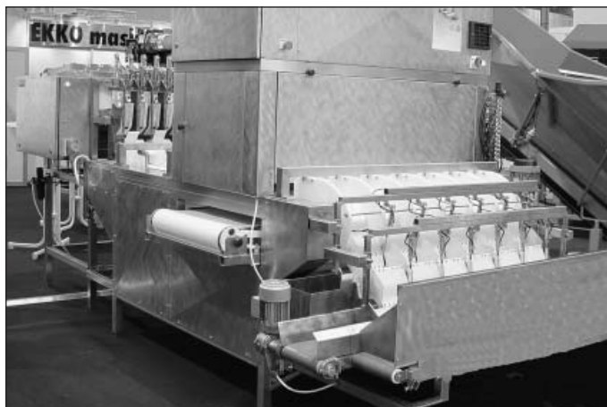
Bild 1: Erste elektronische Verleseautomaten werden zum Qualitätsverlesen gewaschener Kartoffeln eingesetzt
