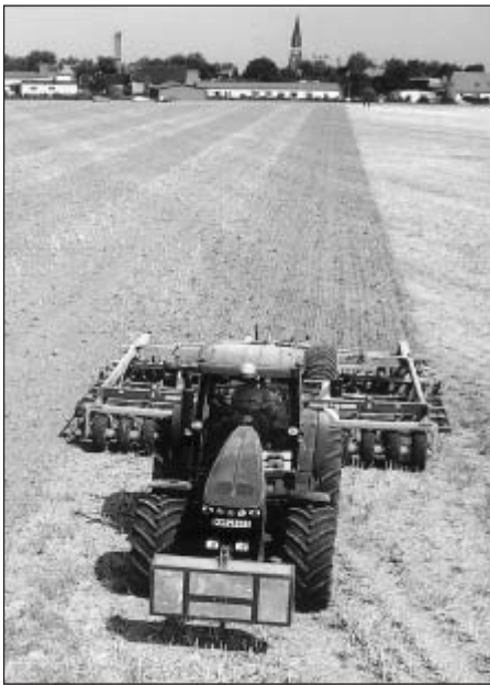
Bild 1: Spurgenaues Anschlussfahren dank AutoTrac Lenkautomatik von John Deere
