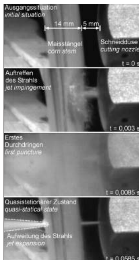
Bild 4: Durchschussversuch an einem Maisstängel
