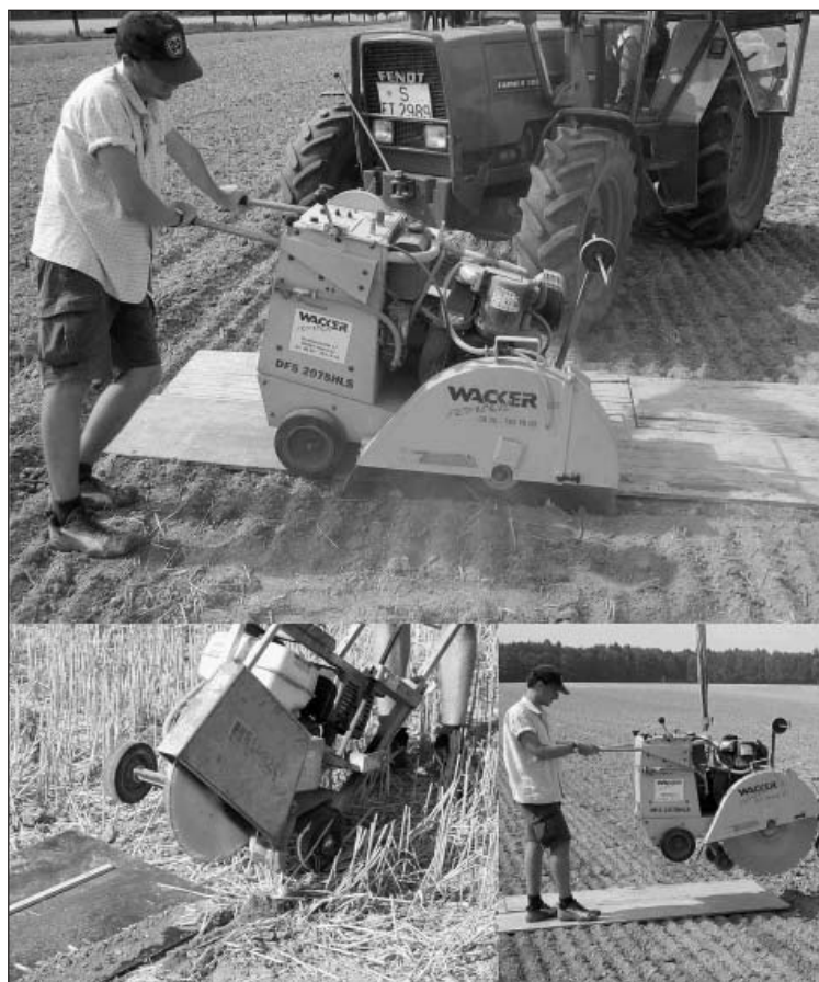
Bild 1: Großer und kleiner Asphaltfugenschneider für unterschiedliche Arbeitstiefen
