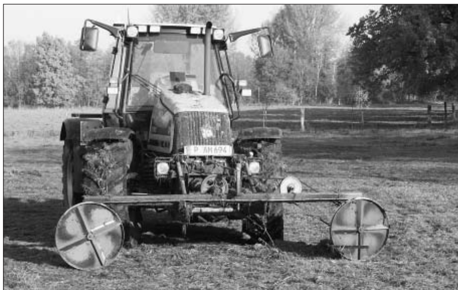
Bild 2: Zweites Forschungsmuster des Bandmähers, 2003
