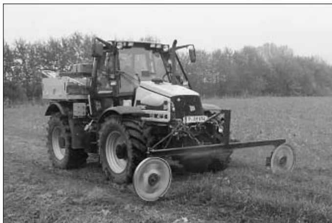
Bild 1: Erstes Forschungsmuster des Bandmähers, 2002
