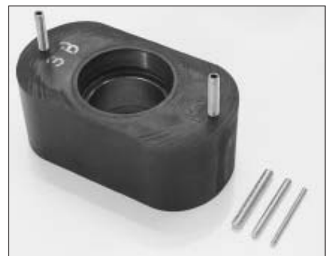
Bild 2: Verdrängungskörper im Kolbenkopf
