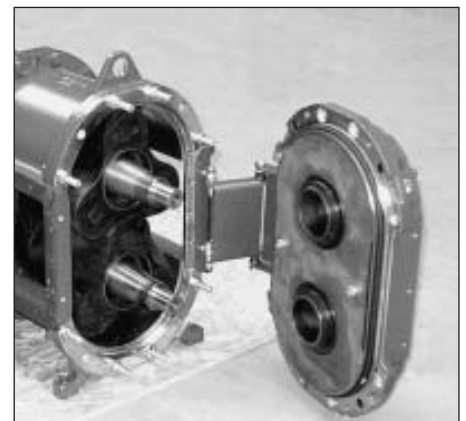
Bild 4: Pumpendeckel mit zusätzlicher Wellenlagerung
