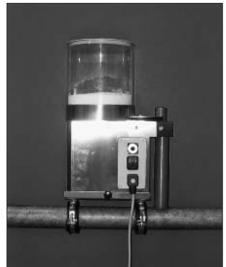
Bild 3: Mit dem MS Dry Dos von Schippers lassen sich Medikamente in Pulverform einfach und genau dem Trockenfutter beimischen.
