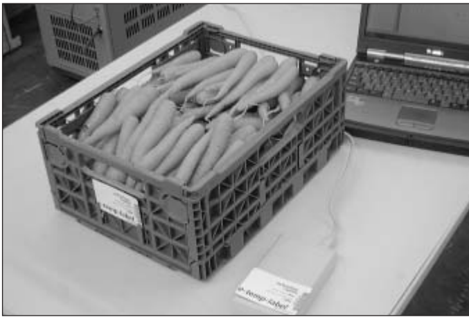
Bild 2: Sensorkarte, Schreib-/Leseinheit und Hostcomputer im praktischen Einsatz bei der Temperaturkontrolle von Möhren
