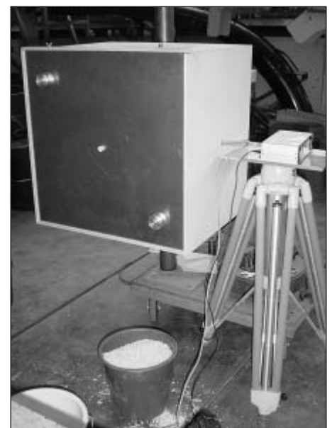
Bild 1: Rotierender Würfel zur Staubmessung
