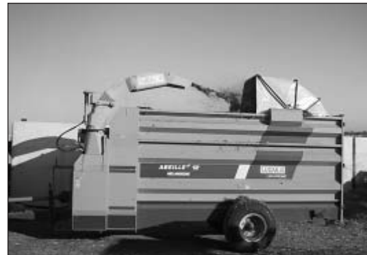
Bild 2: Ballenauflöser (System Lucas) am Traktor angehängt für variable Zerkleinerung von Pferdemist und Aufsetzen der Mieten
