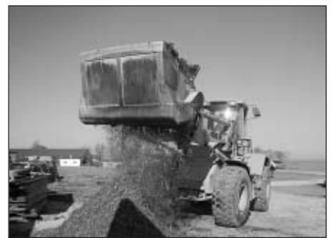
Bild 1: Schaufelaufbereiter (System Allu) am Radlader für Aufnahme, Transport, Zerkleinerung von Pferdemist und Aufsetzen der Mieten
