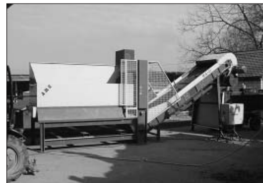
Bild 3: Spezieller Pferdemisthäcksler (System Wüller) von Elektromotoren angetrieben mit Dosiereinheit (links) und Schredder (rechts)
