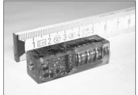
Bild 1: Implantierbarer Datensender (alle Teile sind eingegossen in einen Epoxydharzblock; rechts sind die Knopfzellen, links die elektronischen Funktionsbaugruppen, und links außen einer der beiden Ladekontakte zu sehen)
