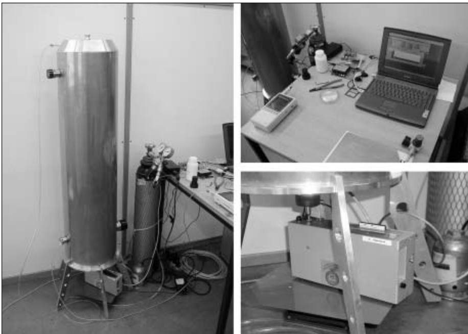
Bild 1: Sedimentationszylinder (links) mit Datenerfassung (rechts oben) und Aerosolspektrometer (rechts unten)
