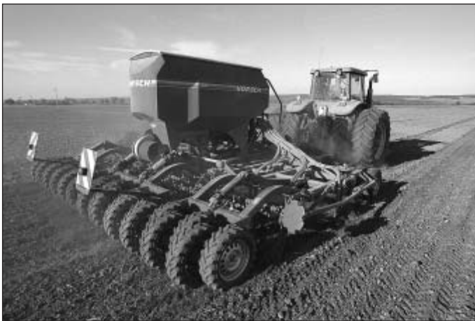
Bild 2: Mit dem Sprinter ST mit 4 oder 6 m Arbeitsbreite rundet Horsch sein Programm an Mulchsaatmaschinen nach unten ab (Werkbild)
