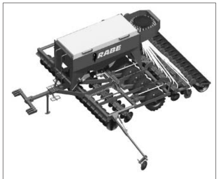
Bild 1: Mit den Arbeitsbreiten 4,5 und 6 m bietet Rabe seine neue gezogene Drillmaschinenfamilie sowohl für Pflugsaat als auch für Mulchsaat an. Der Saattank hat ein Volumen von 3000 l (Werkbild)
