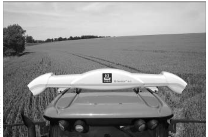
Bild 3: Der neue aktive Yara N-Sensor ® ALS ist mit eigenen Lichtquellen ausgestattet und kann auch nachts die zu düngende Menge bestimmen
