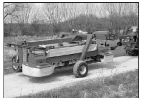
Bild 1: Der gezogene Scheibenmäher GMS 4802 von JF-Stoll mit 4,6 m Mähbreite legt von 9,2 m Arbeitsbreite ein Doppelschwad von 2,8 m ab und ist in Transportstellung 3 m breit.
