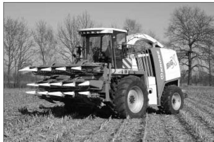
Bild 3: Der stärkste Krone Feldhäcksler Big X 1000 - hier mit reihenunabhängigem Maisgebiss in Transportstellung - verfügt über zwei 6-Zylinderreihenmotoren, die über Gleichlaufgetriebe an den Kurbelwellen verbunden sind, und erreicht so eine Nennleistung von 730 kW
