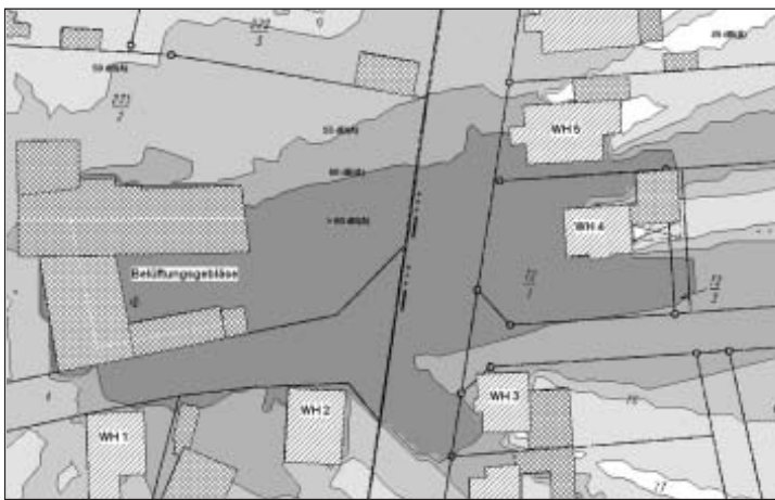
Bild 1 und 2: Rasterberechnung mit Darstellung der Isoflächen für die Bereiche < 45 dB(A), 50 dB(A), 55 dB(A) und > 60 dB(A). Schallquelle ist ein Getreidebelüftungsgebäude mit einem fiktiven Schallleistungspegel von 105 dB(A). Betriebsdauer entspricht der Beurteilungszeit (tags). Die Bilder zeigen die Geräuschverteilung in der Umgebung der Anlage in 5,60 m Höhe. In Bild 2 (rechts) wird um das Aggregat eine Lärmschutzwand aufgestellt, wodurch der Tages-Richtwert von 60 dB(A) für das Dorfgebiet im Bereich der Nachbarwohnbebauung eingehalten werden kann.
