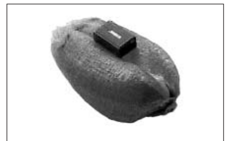
Bild 2: RFID-Transponder (mic3@TAG, microsensus, Erfurt) im Größenvergleich zu einem Weizenkorn
