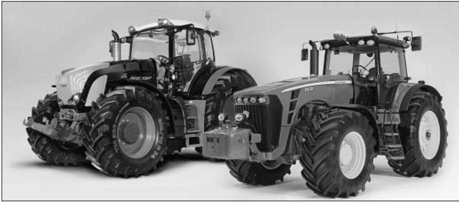
Bild 1: Gewinner der Goldmedaillen der Agritechnica 2005: Fendt 936 Vario (243 Nenn-kW ECE, 2006) und John Deere Reihe 8030 (158 bis 236 Nenn-kW ECE R24, 2006)
