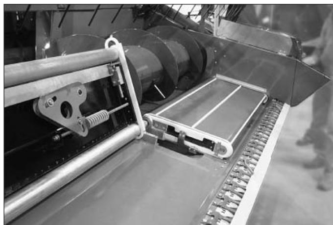
Bild 3: Premium-Flow-Schneidwerk von Zürn und John Deere, links: hochgeklapptes Segment mit Spannvorrichtung, ohne Band
