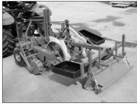
Bild 2: Für Meerrettich modifizierte Gemüsepflanzmaschine - Entwicklungsstufen
