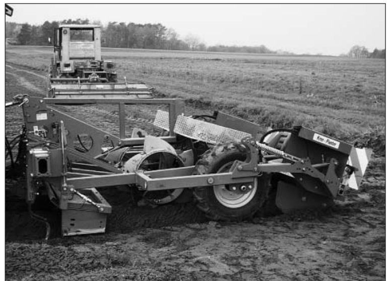
Bild 3: Meerrettichpflanzmaschine „Kren-Planter“ (System Weihenstephan)
