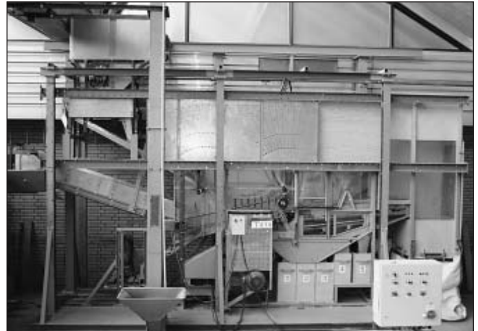
Bild 1: Hohenheimer Versuchsstand für Untersuchungen am Vorbereitungsboden
