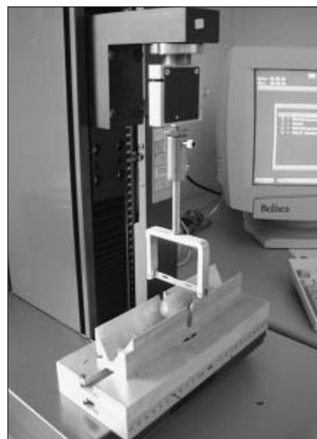
Bild 1: Zum Schneiden wurde ein an einer Universalprüfmaschine (Zwicki 1120, Zwick GmbH & Co. KG, Ulm) angebautes Mikrotommeser (Feather S35, 0,26 mm Dicke) genutzt.
