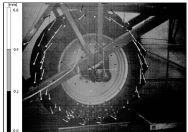
Bild 4: 1. Vertikale Eigenmode im oberen Umkehrpunkt bei \sim 30 \text{ Hz}
