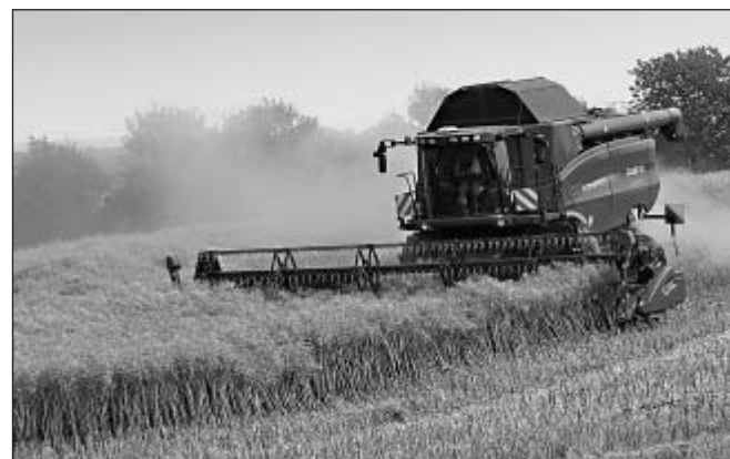
Bild 2: Case verwendet in seinem neuen Axial-Flow 9010 einen Small Tube Rotor, der vor allem bei feuchtem und zähem Erntegut von Vorteil ist (Werkbild)
