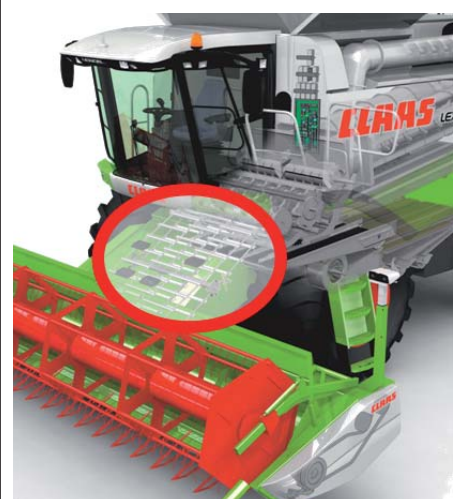
Einzugsketten am Schrägförderer Fig. 3: Feeder house conveyor chains
