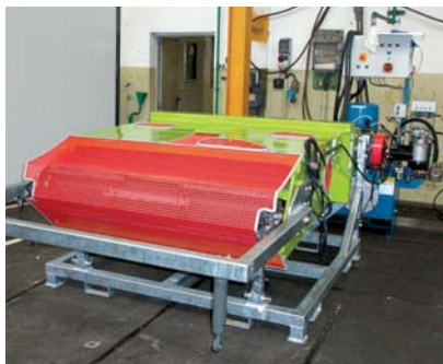
Prüfstand zur Untersuchung der Schrägfördererketten. Foto: Claas Fig. 4: Test stand for feeder house conveyor chain examination
