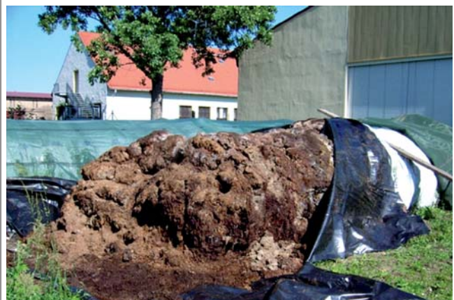
Feucht konservierte Hanfganzpflanzen in einem Siloschlauch Fig. 1: Wet preserved hemp as a raw material for fibre board production
