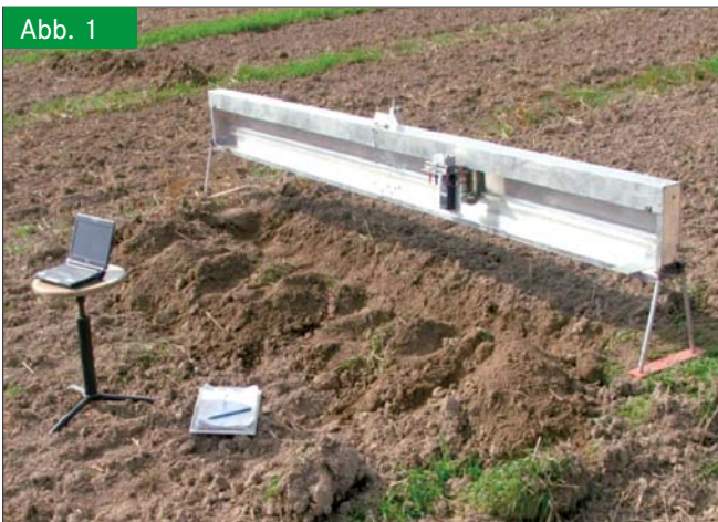
Bodenprofilmessgerät mit Notebook. Foto: HfWU Fig. 1: Profile meter to evaluate soil surface with Notebook
