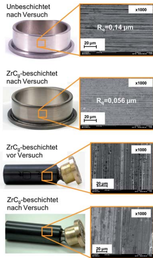
Wälzlager und Kolben aus den Versuchen in einer Axialkolbenpumpe Fig. 2: Rolling bearings after test (top), pistons before and after test (bottom)
