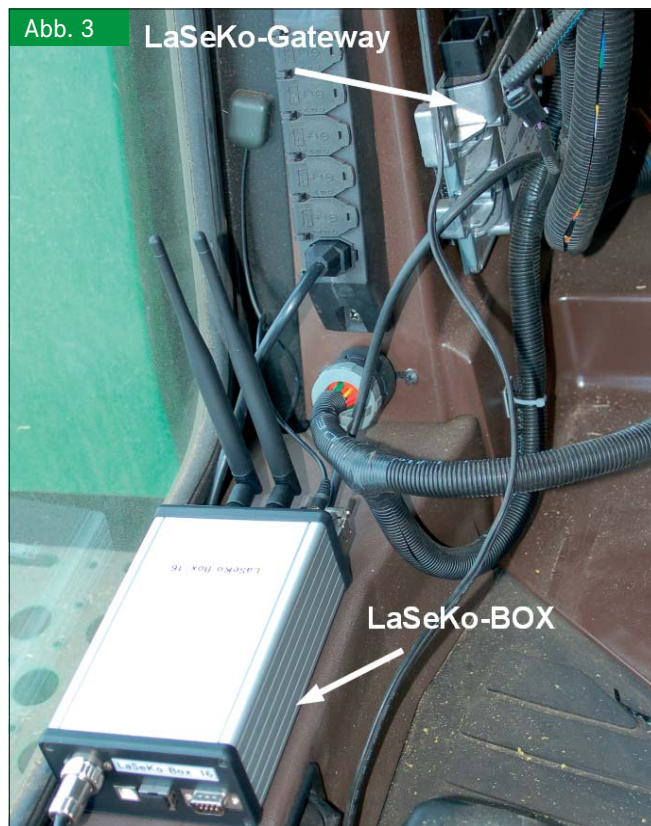
Gateway und LaSeKo-BOX in der Mähdrescherkabine (Foto: Rusch)
