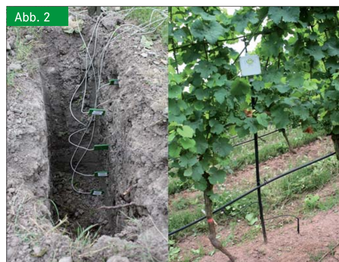
Abbildung 2: Bodenfeuchtesensoren (links, beim Einbau) und Funkknoten zur drahtlosen Datenübertragung der Bodenfeuchtemesswerte (rechts). Fotos: Universität Hohenheim Fig. 2: Soil moisture sensors (left) and wireless node for data transfer of soil moisture data (right)
