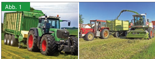
Grassilagebereitung mit dem Ladewagen (links) und in der Häckselkette (rechts) (Fotos: Technische Universität München) Fig. 1: The grass silage preparation with the load carriage (left) and in the harvesting chain
