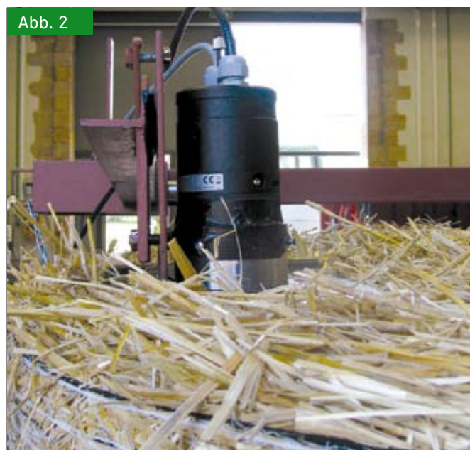
Messkopfplatzierung für radiale Messungen am Ballen Fig. 2: Measuring head installation for radial measurements on bales
