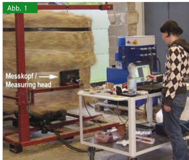
Aufbau des Prüfstandes mit tangentialer Messkopfanbringung Fig. 1: Assembling of test rig with tangential sensor mounting
