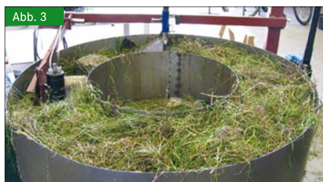
Prüfstand für die Messung von losem Erntegut Fig. 3: Test rig for measurement of bulk crop
