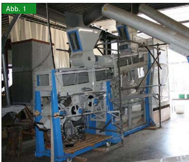
Neuer Reinigungsprüfstand, Universität Hohenheim Fig. 1: New test rig for cleaning units, University of Hohenheim
