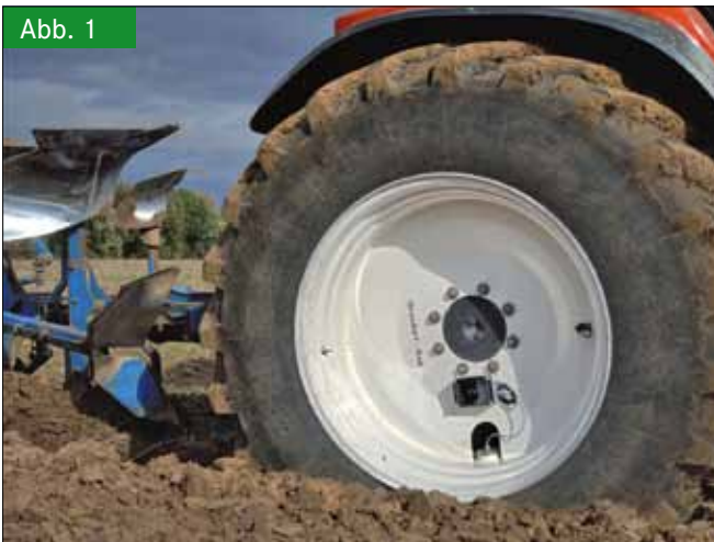
Radlastmessung in der Pflugfurche Fig. 1: Wheel load measurement in the plough furrow
