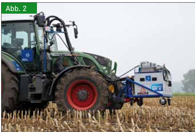
Applikation von PEMS am Fahrzeug Fendt 720 Vario (Foto: Mathies) Fig. 2: Application of PEMS on the vehicle (Fendt 720 Vario)
