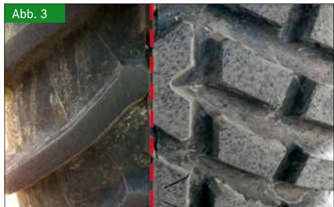
Vergleich von AS-Bereifung (links) und Industriebereifung (rechts) Fig. 3: Comparison of AG tires (left) and industrial tires (right) (Foto: Reckleben)
