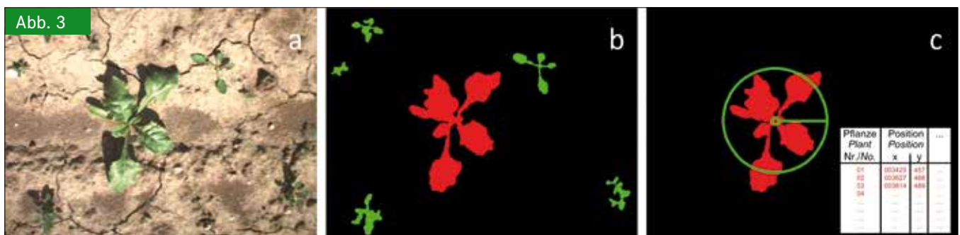
Originalaufnahme (a), Binärbild nach Schwellenwertverfahren (b), Binärbild mit markierter Pflanzenposition (c), (Foto: Mütter) Fig. 3: Original image (a), binary image after thresholding (b), image with identified plant position (c)
