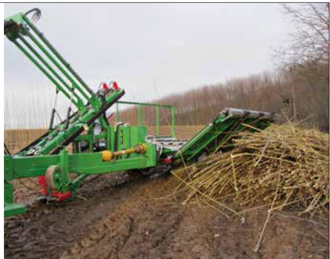
Sägeblätter und Einzugsbänder (links), abgeladene Pappelaufwüchse (rechts) (Fotos: Peschel, TU Dresden) Fig. 3: Saw blades and feeder belts (left), unloaded poplar rods (right)
