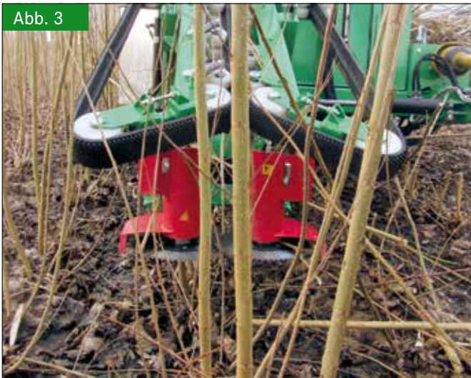
Sägeblätter und Einzugsbänder (links), abgeladene Pappelaufwüchse (rechts) (Fotos: Peschel, TU Dresden) Fig. 3: Saw blades and feeder belts (left), unloaded poplar rods (right)
