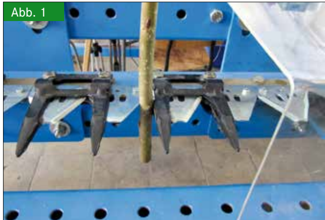
Abb. 1 Versuchsstand mit Schnittbereich (links), Schnittkräfte am Messerbalken bei erntefrischen Pappelruten (rechts) (Foto: Peschel, TU Dresden) Fig. 1: Test stand with cutting distance (left), cutting forces of a cutting bar with fresh poplar rods (right)
