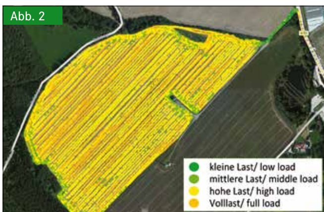
Aufgenommene Motorlastdaten eines John Deere 8360R Fig. 2: Logged engine load data of a John Deere 8360R
