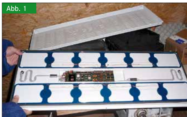
Ein Antennenblock („Antenne“) aus 12 einzelnen Antennenspulen in zwei Reihen, ohne Abdeckung (Foto: S. Gebhardt-Henrich) Fig. 1: Antenna pad („antenna“) with 12 single antennas in two rows, top of the antenna is removed
