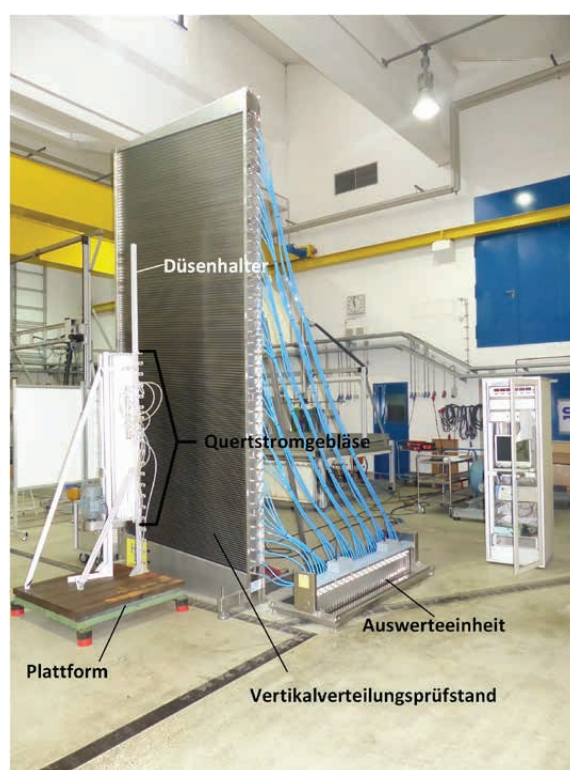
Abbildung 1: Versuchsaufbau, bestehend aus Vertikalverteilungsprüfstand, verstellbarer Plattform mit Düsenhalter und Querstromgebläse sowie Auswerteeinheit (Foto: H. J. Osteroth)
