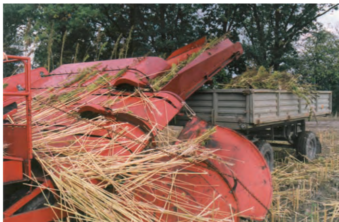
Abbildung 1: Prototyp einer Erntemaschine des IWNIRZ für die querparallele Ablage der Hanfstängel bei gleichzeitiger separater Gewinnung der Blüten- bzw. Samenstände (Foto: R. Kaniewski)
