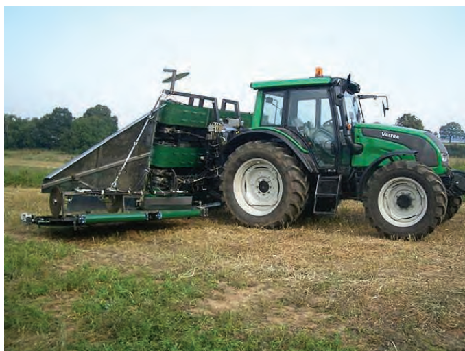
Abbildung 2: Prototyp einer Erntemaschine für die querparallele Ablage der Hanfstängel (Fa. Kranemann) (Foto: H.-H. Kranemann)
