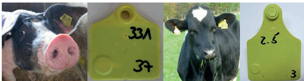
Abbildung 1: Ultrahochfrequente Schweine- und Rinder-Transponder-Ohrmarke (© N. Hammer)
